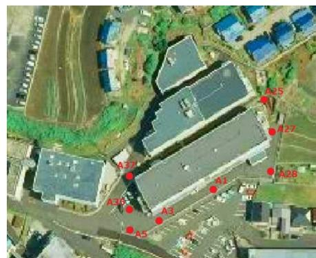
図 1 基準点配置図
