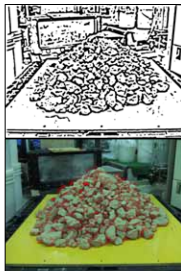
図-3 各岩石のエッジ抽出状況 ラプラシアン処理後（上）、 エッジ抽出線の重ね合せ（下）
