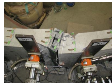
写真-2 追従機構近傍の状況(最大荷重時)
