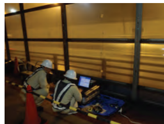
写真-2 遮煙壁振動調査状況
