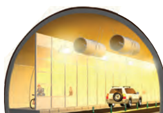
図-1 遮煙壁設置状況
