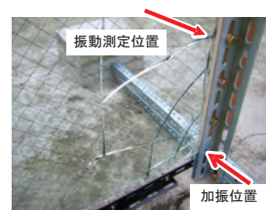
写真-1 ガラス破壊実験状況
