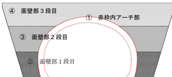
図-1 打設割付け図
