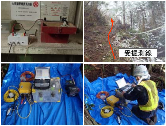
写真 1 坑内起爆信号検出装置(左上), 受振側線設置状況(右上), 地表計測器一式(左下), 計測状況(右下)
