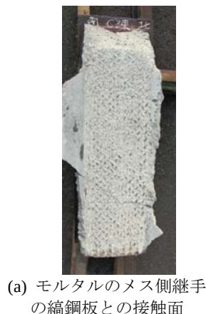
図-4 せん断試験結果
