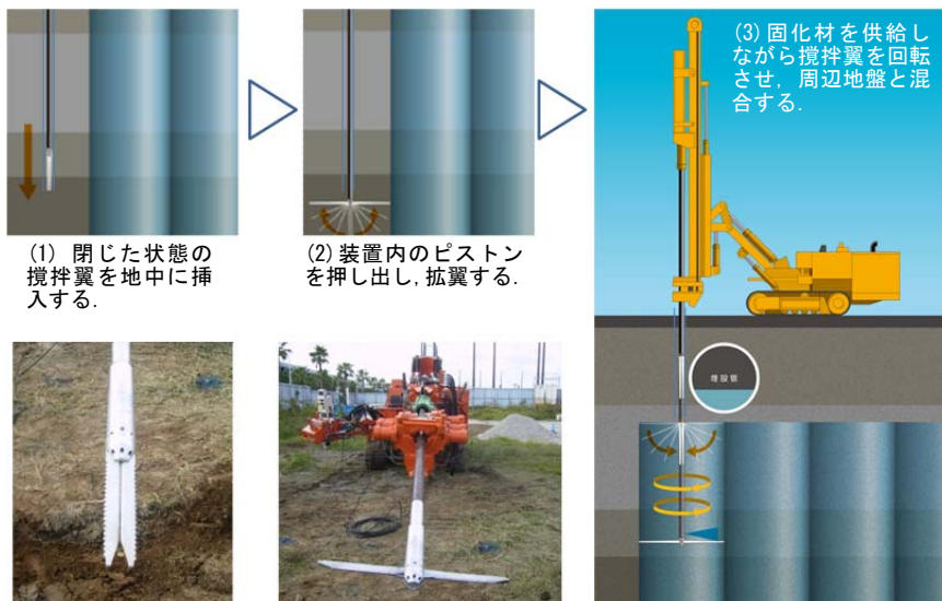
図-1 施工試験の概要
