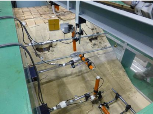
写真-1 case2(700gal 加振後)の盛土崩壊状況
