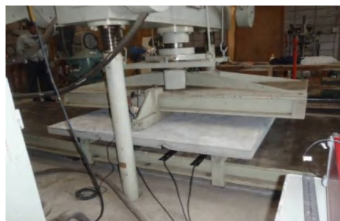
図-2 曲げ試験に用いた載荷装置
