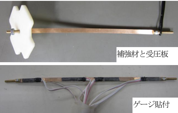
写真-1 補強材と受圧板
