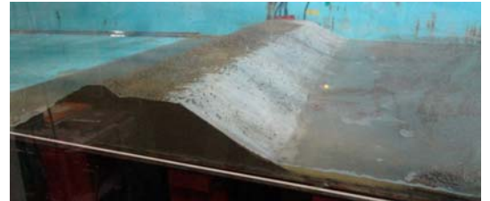
写真2 全面補強（Wet）の越流後
