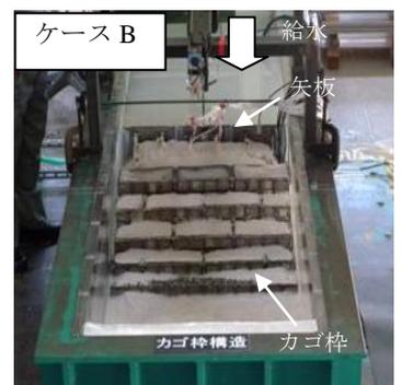
写真2 越流時の堤体の状況 (堤内側から撮影)
