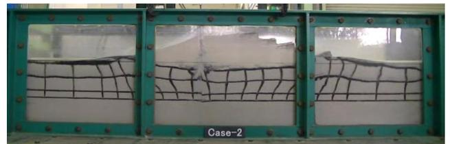
ケースC: 対策構造 (鋼矢板, カゴ枠, アンカー)
