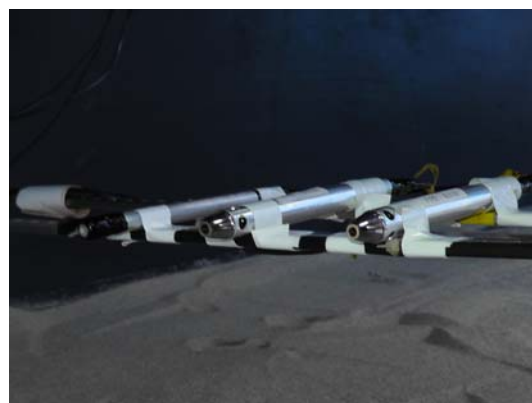
図 1 圧電センサー (カバー無し; 左, カバー内径 5mm; 中, 内径 4mm; 右)
