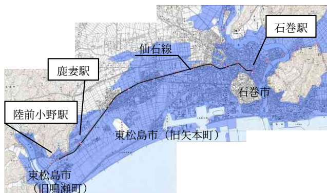
図1 仙石線津波浸水範囲(抜粋)
