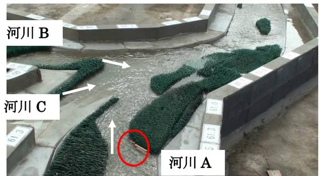
写真-3 樹林帯による流木の捕捉
