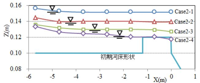
図-4 縦断水面形状 (Y=0.8m)
