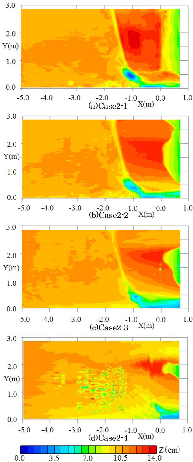
図-3 河床形状のコンター図 (Case2)
