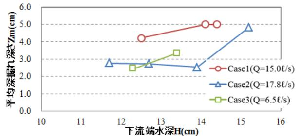
図-6 下流端水位と洗掘深の関係
