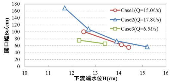
図-5 下流端水位と開口幅の関係
