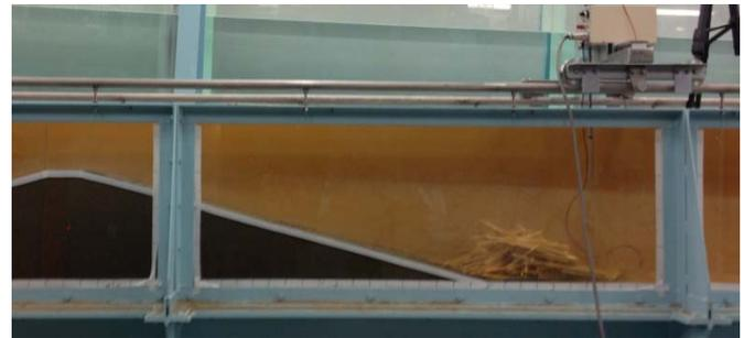
写真 2 流木模型設置状況
