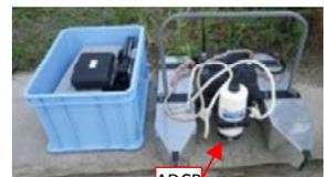
写真-1 計測機器(ADCP)
