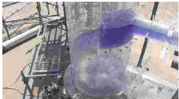
写真-1 人孔壁面に沿った水脈の流況
