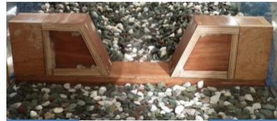
写真1 台形断面型えん堤模型
