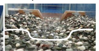
写真4 複断面型河床形状(Case B)
