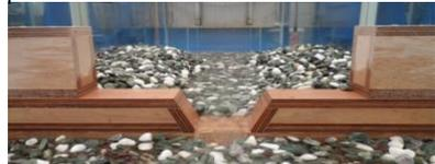
写真2 複断面型えん堤模型
