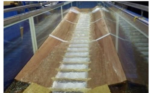
写真2 提案魚道工の模型
