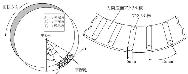
図-1 平衡塊の各諸元 図-2 栈粗度
