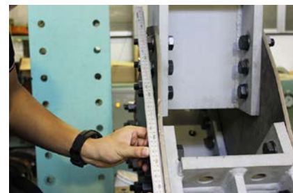
写真-3 L-574 の面外変形状況 (実験終了後)
