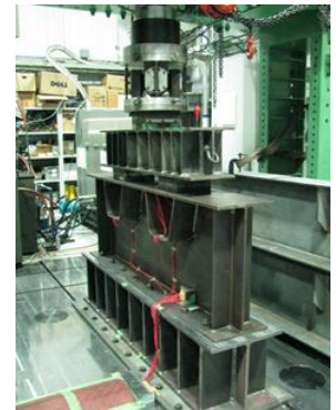
写真 1 疲労試験状況
