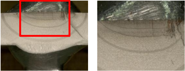
写真 1 AW 試験体破断面
