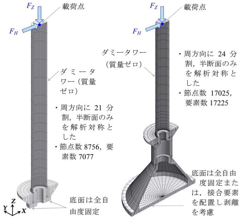
図-2 ①定着部の解析モデル
