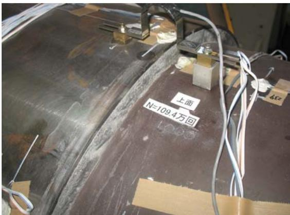
写真 1 疲労試験後のグラウトの状況
