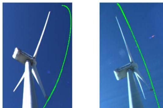
図 2 2 台のカメラによる画像と追尾の例
