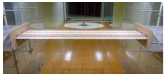
図 2 1/70 部分模型設置状況
