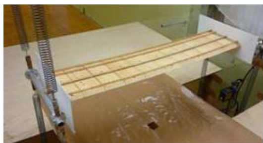
図 4 1/150 部分模型設置状況
