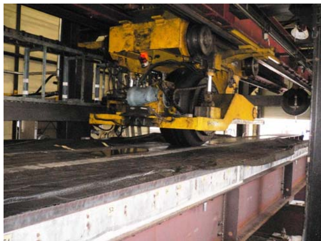
写真-1 輪荷重走行試験状況
