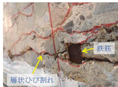
写真-4 荷重中の供試体側面の状況
