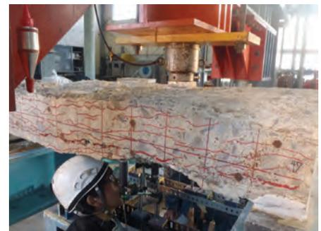
写真-2 押抜きせん断載荷試験の状況
