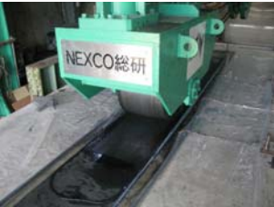
写真 1 移動載荷実験 (水張り条件)
