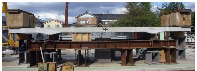
写真-1 壁高欄荷重の載荷状況
