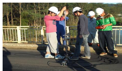
写真2 FWD 試験実施状況
