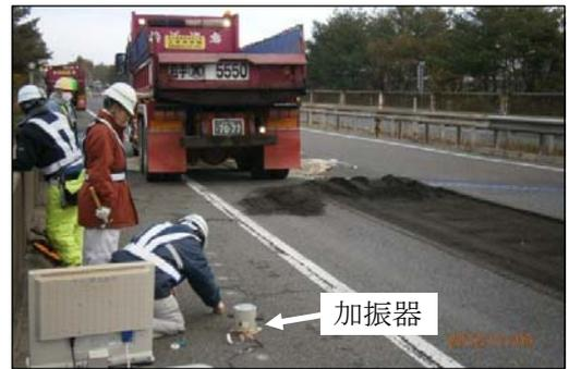
写真-2 開削前(舗装あり)の測定状況
