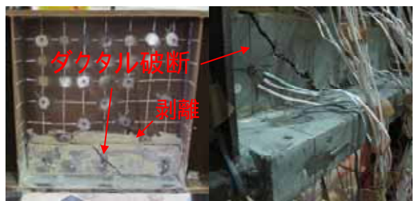
a)ダクトル補修 b)ダクトルギブス補修
