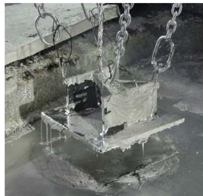
図-2 浸漬実験の様子 (めっき浴引上げ中)
