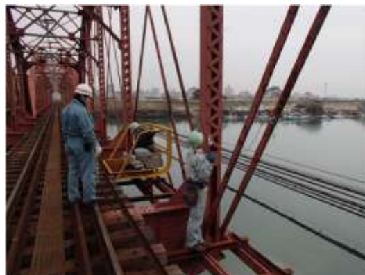
写真-2 アイバー振動測定状況
