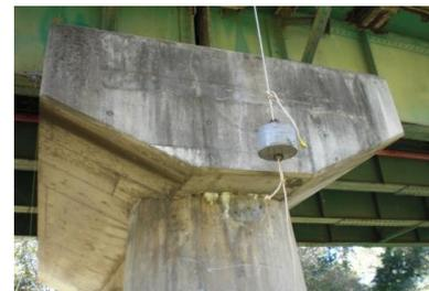
写真-1 橋脚への重錘衝撃試験
