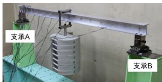
写真-1 供試体全景
