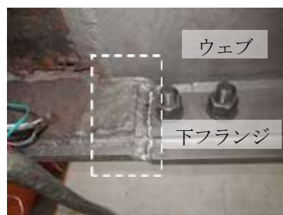
図-4 No.2-2 の破壊性状
