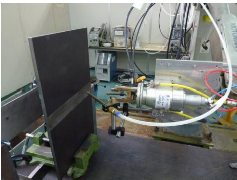
図 4 横向き姿勢施工状況
