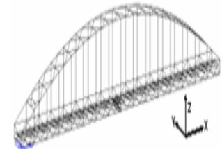
図-6 樺島大橋の上部工モデル
