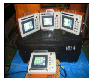
写真-6. 油圧ジャッキモニター
