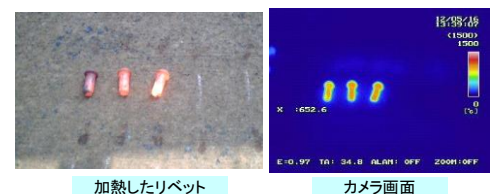
図 2 赤外線カメラによる加熱温度測定
