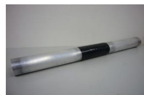
図2 飛来塩分捕集器
