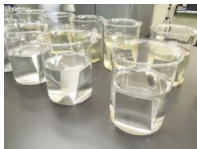
写真-3 促進試験状況 (左: 浸漬中 右: 乾湿繰返し開始前)
