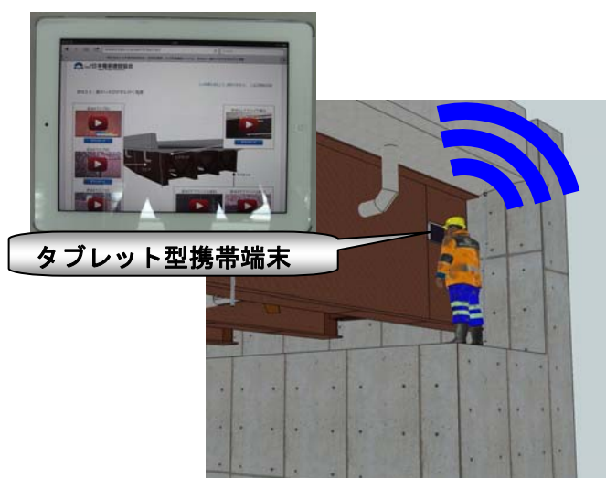
図-5. 映像によるさび評価補助ツール使用イメージ
