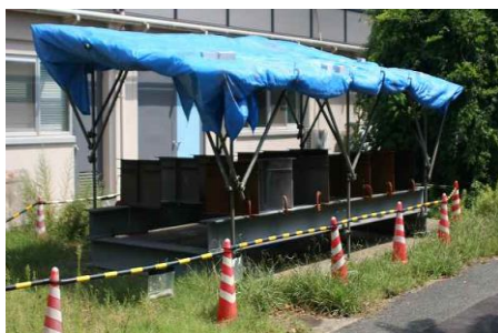
写真 - 1 曝露実験全景 (模型桁)
